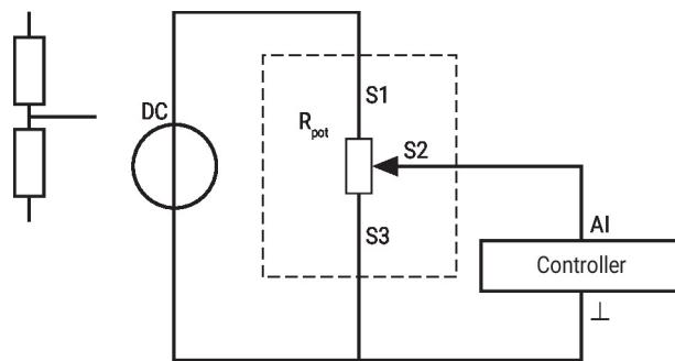
Wird das Potentiometer überwiegend im gleichen kleinen Winkelbereich betrieben, empfehlen wir die Verdrahtung als Spannungsteiler.
