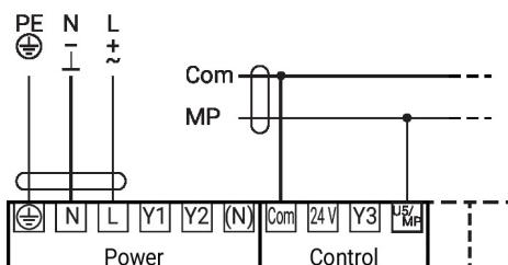
Anschluss BACnet MS/TP / Modbus RTU
