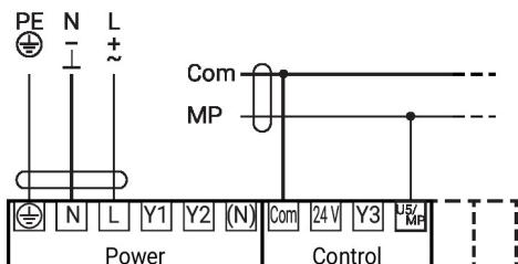
Anschluss BACnet MS/TP / Modbus RTU
