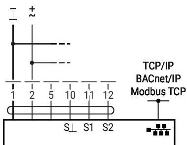
TCP/IP (Cloud) / BACnet/IP / Modbus TCP mit analogem Sollwert
