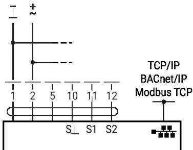
TCP/IP (Cloud) / BACnet/IP / Modbus TCP mit analogem Sollwert (Hybridbetrieb)
