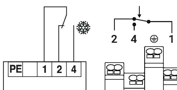
Si el capilar tiene fugas, el interruptor cambia a la posición de congelación.
