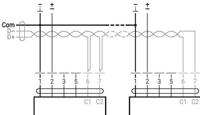
Modbus RTU / BACnet MS/TP con punto de consigna analógico (funcionamiento híbrido)
