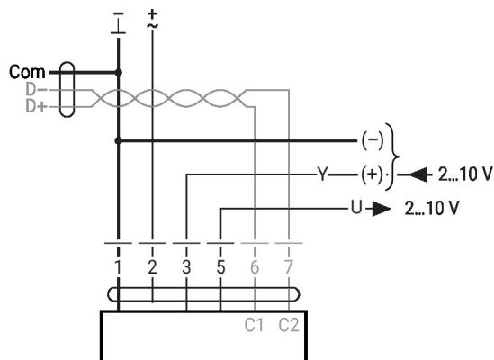
BACnet MS/TP / Modbus RTU
