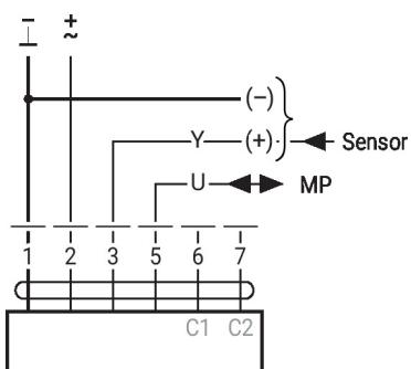
**Instalación eléctrica****Convertidor para sensores**
