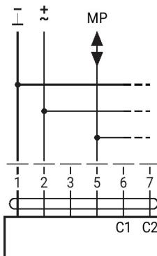
MP-Bus con conexión a 2 hilos,
