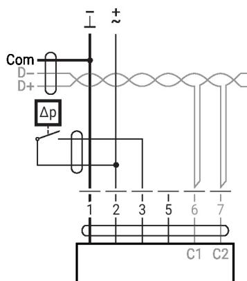
Requisitos del contacto de conmutación: El contacto de conmutación deberá poder conmutar con precisión una corriente de 16 mA con 24 V.
