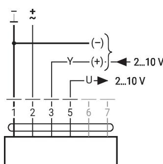
Modbus RTU / BACnet MS/TP con punto de consigna analógico
