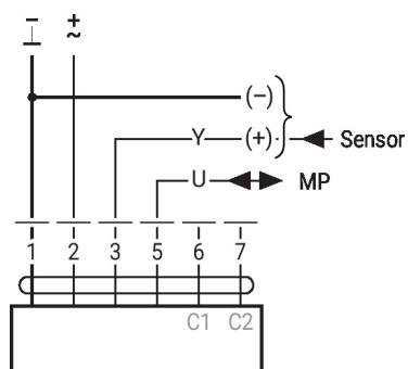
**Convertidor para sensores**
