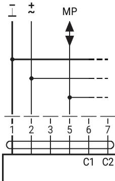
MP-Bus con conexión a 2 hilos, alimentación local
