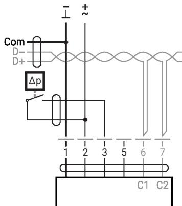
Requisitos del contacto de conmutación: El contacto de conmutación deberá poder conmutar con precisión una corriente de 16 mA con 24 V.
