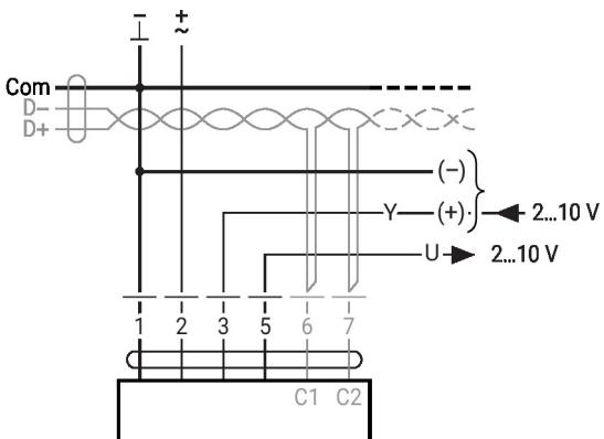
MP-Bus, alimentación a través de una conexión a 3 hilos
