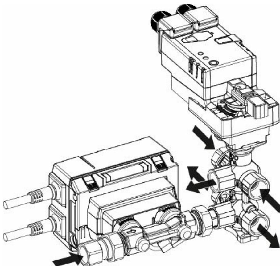
Variante con accesorio P2P..-1GE para una altura de instalación mínima (135 mm)
