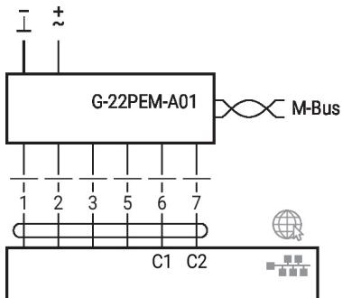
M-Bus en paralelo con Modbus RTU o BACnet MS/TP
