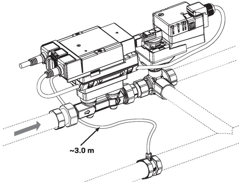
**Instalación split** La combinación de actuador para válvulas puede montarse por separado del caudalímetro. Debe respetarse el sentido del flujo de ambos componentes.
