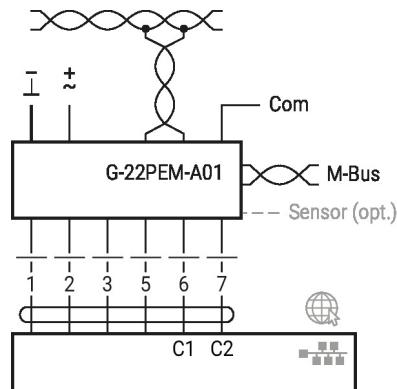
M-Bus en paralelo con Modbus TCP o BACnet/IP
