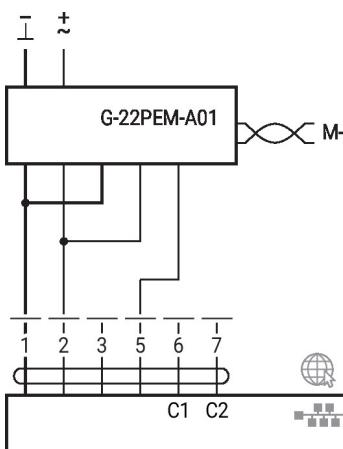
M-Bus en paralelo con Modbus TCP o BACnet/IP con PoE
