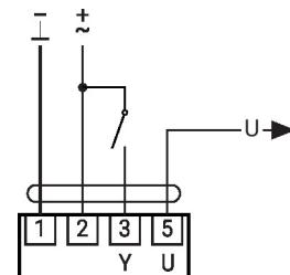
Mandos imperativos y limitador con 24 V AC con interruptor rotativo Control de 3 puntos con 24 V AC
