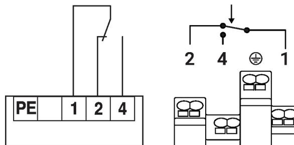
Si el capilar tiene fugas, el circuito eléctrico 1-4 está cerrado permanentemente. Ya no se puede desbloquear.
