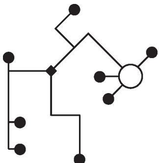
No existen restricciones para la topología de la red (se permite en estrella, anillo, o mezcladas). Alimentación y comunicación en un mismo cable de 3 hilos
