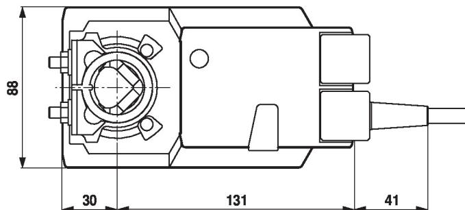
Cuando se utiliza un eje redondo de CrNi (INOX):  $\varnothing 12 \dots 20$  mm
