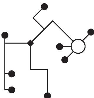
No existen restricciones para la topología de la red (se permite en estrella, anillo, o mezcladas). Alimentación y comunicación en un mismo cable de 3 hilos
