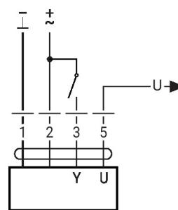
Mandos imperativos y limitador con 24 V AC con interruptor rotativo Control de 3 puntos con 24 V AC
