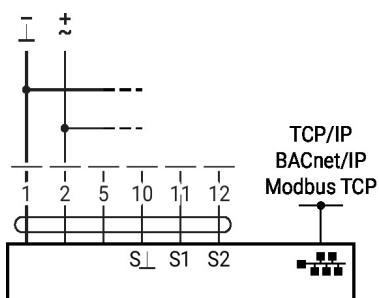
TCP/IP (Nube) / BACnet/IP / Modbus TCP con punto de consigna analógico (funcionamiento híbrido)
