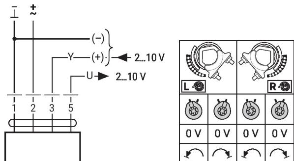
Diagrama eléctrico del funcionamiento en tandem (actuadores de acoplamiento mecánico)
