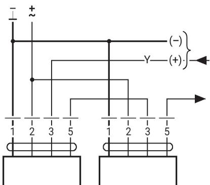
Máx. 2 actuadores en funcionamiento primario/ secundario
