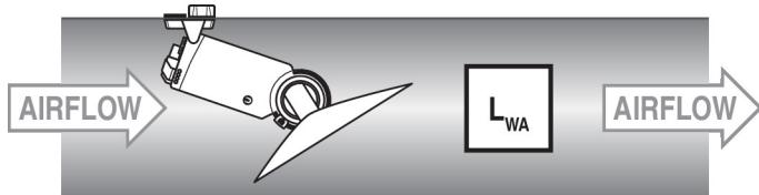
**Nivel de potencia de sonido LWA** Nivel de potencia de sonido con evaluación A, incluida la corrección del reflejo de la salida LWA
