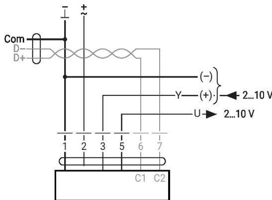
BACnet MS/TP/Modbus RTU
