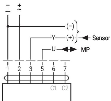
**Instalacion electrica****Convertidor para sensores**
