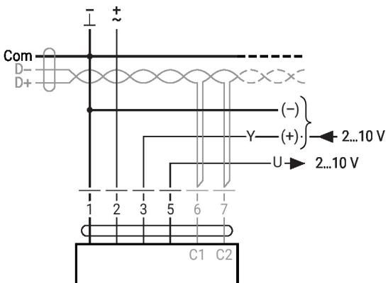
MP-Bus, alimentación mediante una conexión a 3 cables
