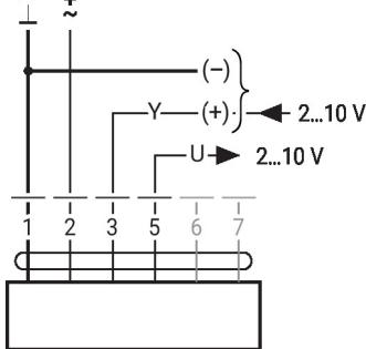
Modbus RTU / BACnet MS/TP con valor de referencia analógico
