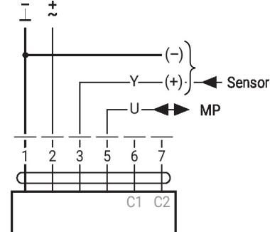
**Instalacion electrica****Convertidor para sensores**
