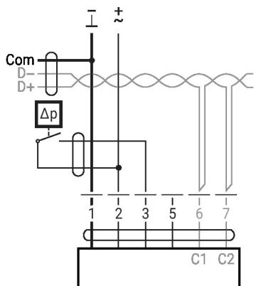
Requisitos del contacto de conmutación: El contacto de conmutación debe poder conmutar con precisión una corriente de 16 mA con 24 V.
