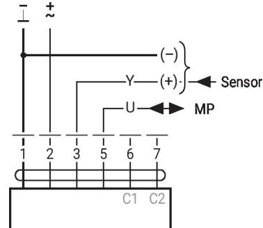
**Instalacion electrica****Convertidor para sensores**
