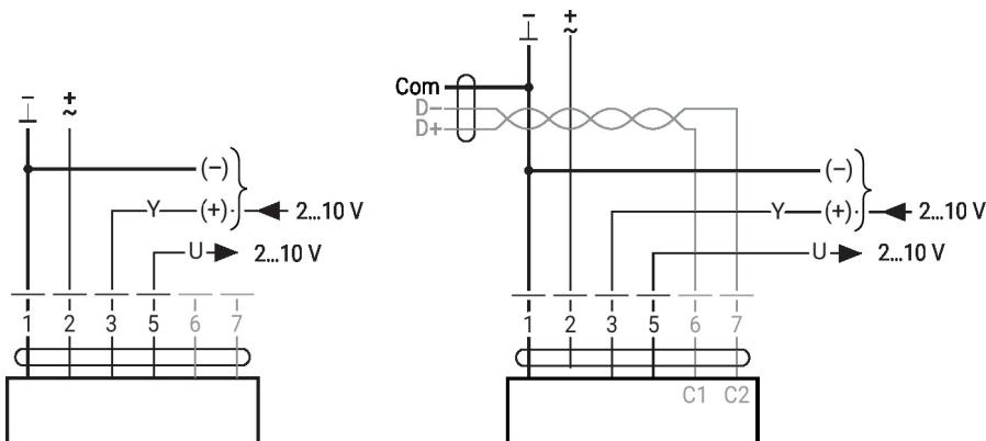
BACnet MS/TP/Modbus RTU
