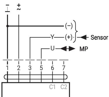
**Instalacion electrica****Convertidor para sensores**
