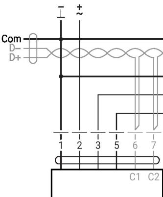
MP-Bus, alimentación mediante una conexión a 3 cables
