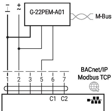
Ejemplos de cableado externo con modelos de actuador ..24G..
