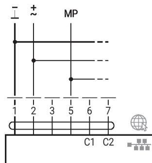
PoE con BACnet/IP/Modbus TCP
