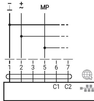
PoE con BACnet/IP/Modbus TCP
