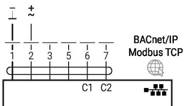
PoE con BACnet/IP/Modbus TCP
