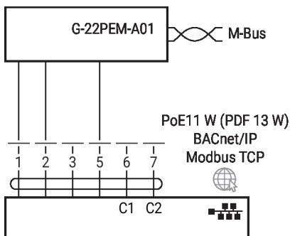
M-Bus con convertidor en modo paralelo con BACnet/IP/Modbus TCP
