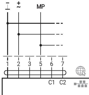
MP-Bus con conexión a 2 cables, fuente de alimentación local
