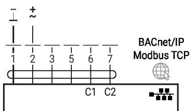
PoE con BACnet/IP/Modbus TCP
