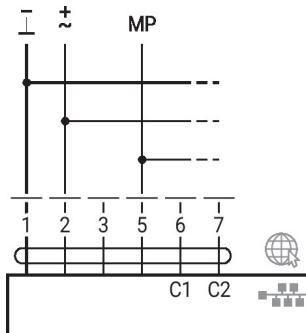
MP-Bus con conexión a 2 cables, fuente de alimentación local
