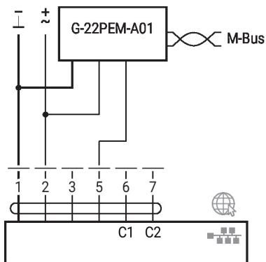
M-Bus con convertidor en modo paralelo con PoE con BACnet/IP/Modbus TCP
