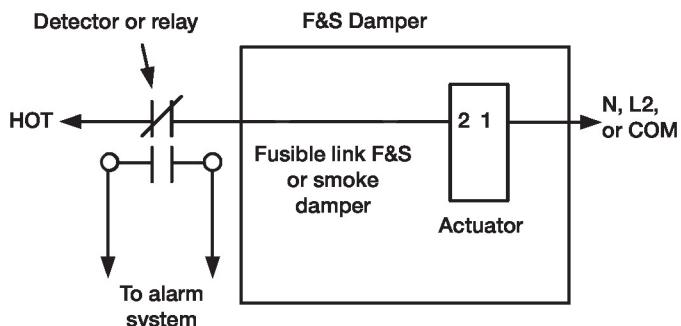
Cableado típico de compuerta de protección contra humos o de enlace fusible
