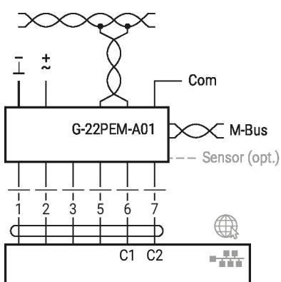
Connexion avec capteur actif
