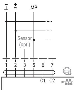
MP-Bus par un raccordement à 2 fils, alimentation locale
