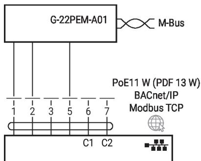
M-Bus parallèle, Modbus RTU ou BACnet MS/TP
