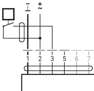
Connexion avec capteur passif
