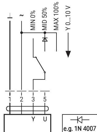
Commande à distance de 0...100 % Limitation minimale avec positionneur SG..
