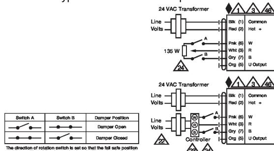
Servomoteurs multiples à potentiomètre de position minimale
