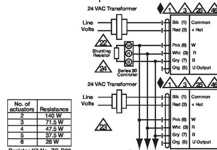
Servomoteurs multiples utilisés avec W973, W7100 et T775
