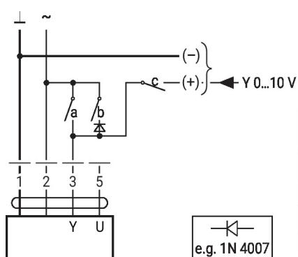
Commande de surpassement avec interrupteur rotatif AC 24 V
