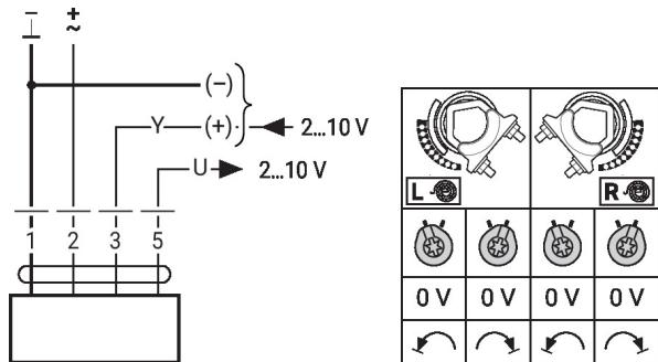
Schéma de câblage pour application superposée (servomoteurs couplés de manière mécanique)
