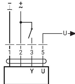
Commande de surpassement et limitation de positionnement avec interrupteur rotatif AC 24 V
