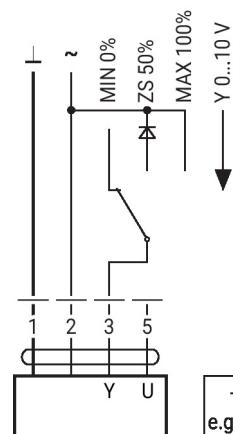
Commande à distance de 0...100 % Limitation minimale avec positionneur SG.. avec positionneur SG..
