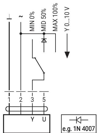
Commande à distance de 0...100 % Limitation minimale avec positionneur SG.. avec positionneur SG..
