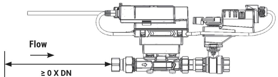
**Installation fractionnée** La combinaison robinet/servomoteur peut être montée séparément du capteur de débit. Le sens du débit des deux composants doit être respecté.
