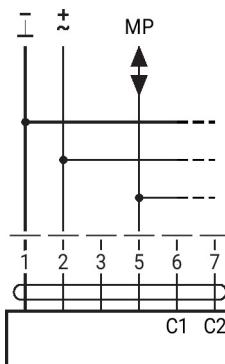
Bus MP par un raccordement à 2 fils, alimentation locale
