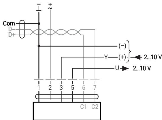
BACnet MS/TP / Modbus RTU
