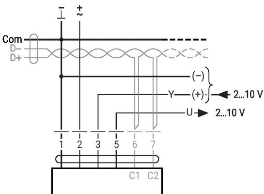
Bus MP, alimentation par un raccordement à 3 fils
