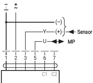
**Installation électrique****Convertisseur pour capteurs**
