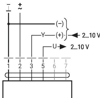
Connexion Modbus MS/TP / BACnet RTU avec point de consigne analogique (fonctionnement hybride)
