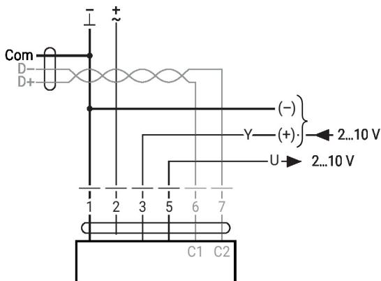
BACnet MS/TP / Modbus RTU
