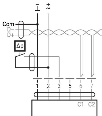
Exigence relative au contact de commutation : le contact de commutation doit pouvoir commuter un courant de 16 mA à 24 V avec précision.
