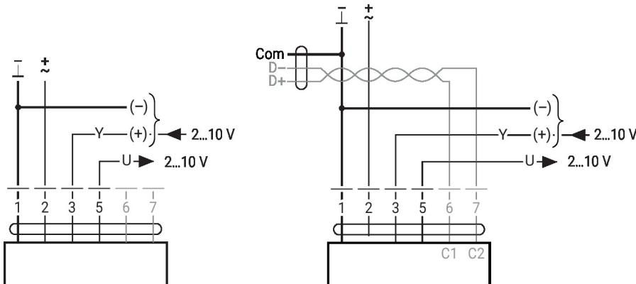
BACnet MS/TP / Modbus RTU
