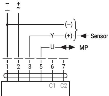
**Installation électrique****Convertisseur pour capteurs**
