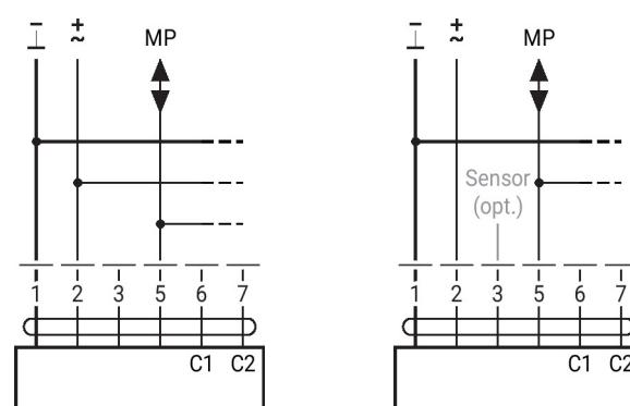
Bus MP par un raccordement à 2 fils, alimentation locale
