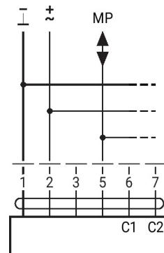
Bus MP par un raccordement à 2 fils, alimentation locale
