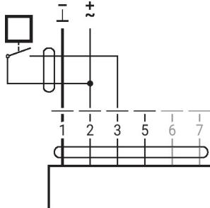
Connexion avec capteur actif
